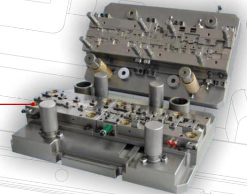
**Modulares Werkzeug mit Doppelkontaktschweißen**
